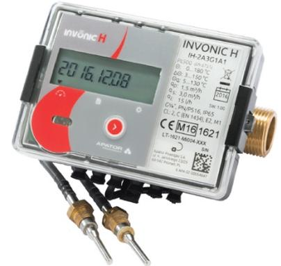
Il corpo del misuratore in ottone è disponibile in versione filettata o versione flangiata ed è protetto dai campi magnetici esterni mentre le diverse modalità di trasmissione permettono di scaricare i dati a distanza tramite cavo (M-Bus, ModBus RTU, impulso / uscita analogica) o wireless (Wireless M-Bus 868 Mhz), consentendo la collaborazione di INVONIC H con diversi sistemi più complessi di automazione e lettura dati
