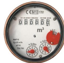
Contatore IP68 (solo per acqua fredda) collegabile al trasmettitore NK posto nel coperchio di rame, nell'involucro ermetico chiuso con vetro minerale.
